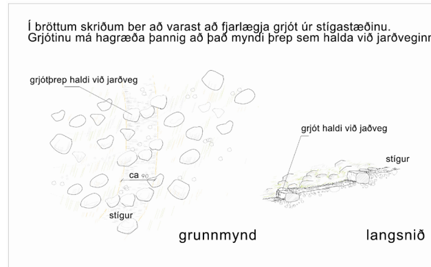
Mynd 16. Skýringarmynd - Grjót notað til stuðnings við stígagerð
