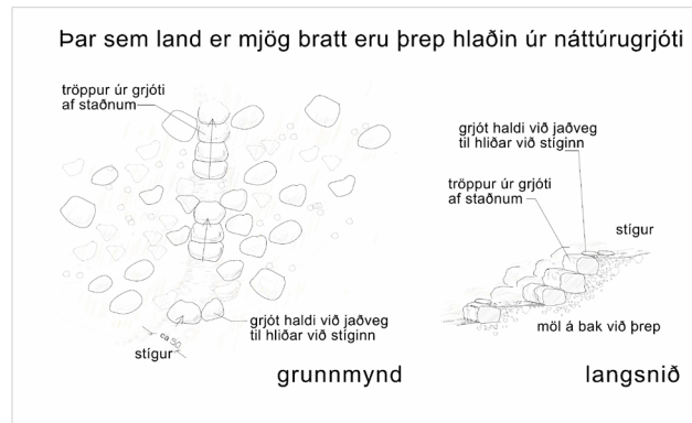
Mynd 17. Skýringarmynd - Hlaðin þrep úr grjóti
